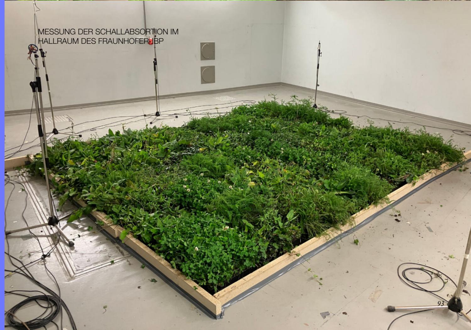
MESSUNG DER SCHALLABSORPTION IM HALLRAUM DES FRAUNHOFER IBP
