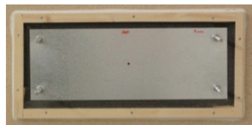
Bild 1: Stahlblech inklusive zentraler Kreisöffnung als Prüfobjekt mit Variation der Öffnungen anhand unterschiedlicher Durchmessern und Tiefen [1].
