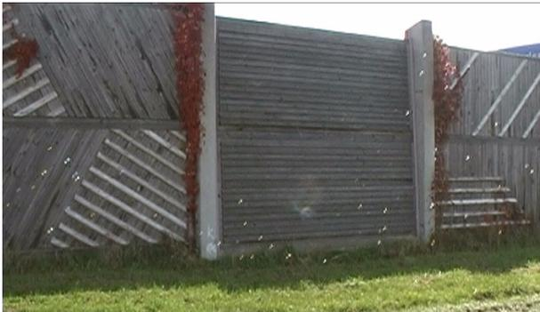
**Bild 2:** Darstellung der Windströmung durch den Flug von Seifenblasen im Messgebiet Zuffenhausen. Standbild der Videoaufzeichnung.
