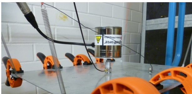
Bild 3: Befestigung eingezwängter Probenstreifen mit Federklemmen als Variante des Messaufbaus zur Bestimmung der Körperschalldämpfung.
