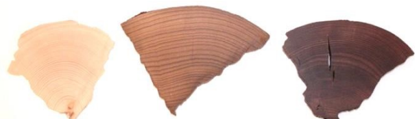
Bild 1: Vergleich der unterschiedlichen Behandlungsstufen. Links: unbehandelte Buche, Mitte: kürzere Behandlungszeit; rechts: längere Behandlungszeit (mit typischen radialen Rissen).
