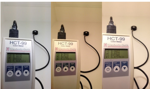
Bild 3: Messung der Farbwerte und der Farbtemperatur von drei verschiedenen Lichtquellen.
